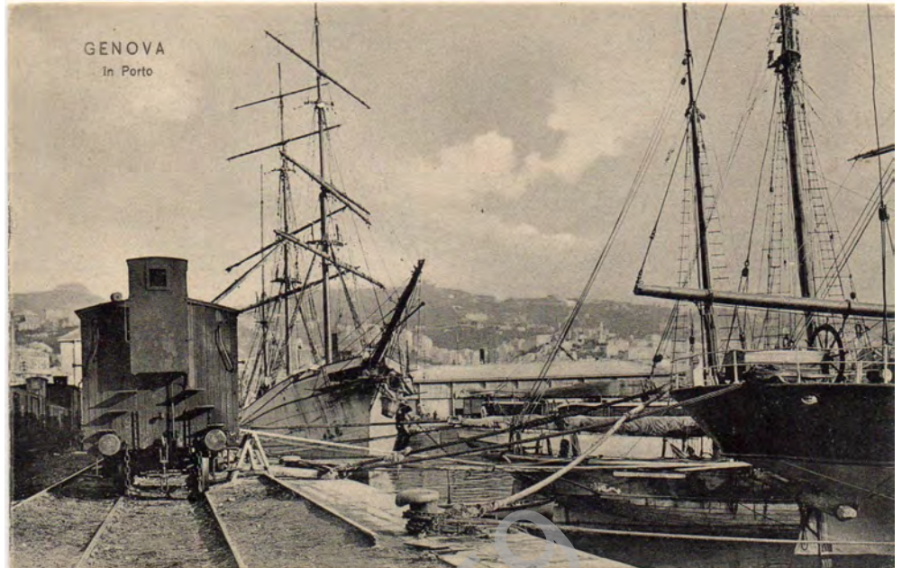
Porto di Genova. Carro merci con garitta del frenatore e catene di sicurezza in ausilio al gancio di trazione per il superamento dei valichi in tempi in cui non era applicato il freno continuo. Cartolina datata 1905. (Archivio Mario Moretti)
